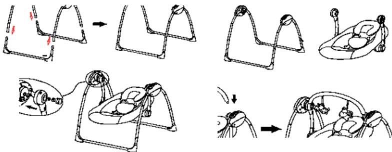
3. Montieren Sie den Sitzrahmen am Kopf des Hauptgestells und dem Hilfsrahmen mithilfe der Schrauben, Auflagen und Kindersicherung, wie in den Abbildungen unten gezeigt. Ziehen Sie dann an den Armlehnen, um sicherzustellen, dass die ordnungsgemäß montiert wurden.
